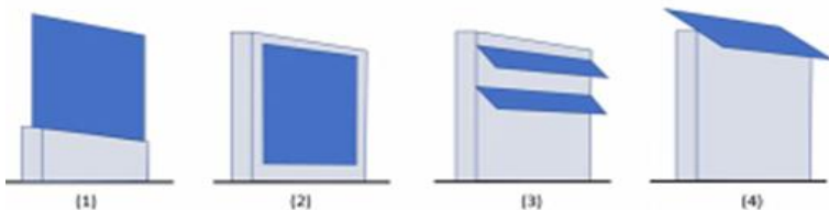
Abbildung 2: Verschiedene Formen von PV-Schallschutz, ©AIT
